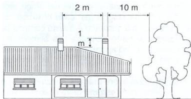
Размеры дымохода могут различаться в зависимости от его модели. Однако, целях обеспечения надлежащего выхода дыма, место прохождения воздуха в дымоходе должно быть в два раза больше чем сама дымоходная труба, а крышка дымохода не должна мешать протоку воздуха
